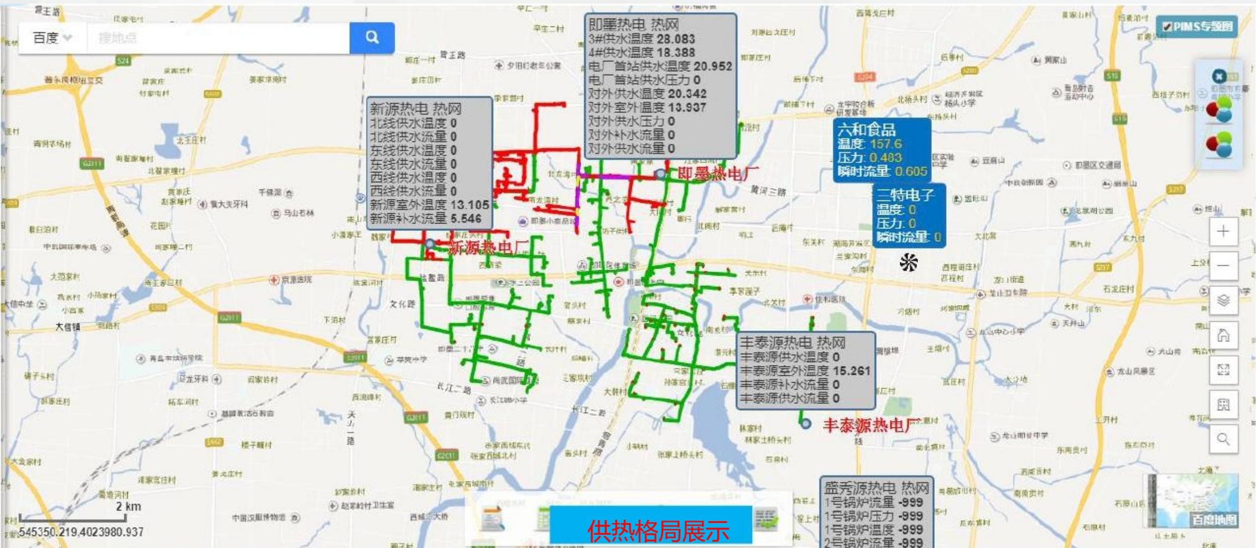
对换热站、热量表、管网监测点、重要事件进行实时监测，从而能够直观了解管网的运行情况，并进行及时调度。
